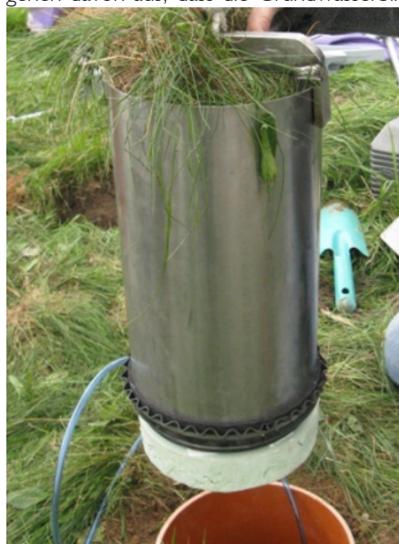
Lysimeter zur Untersuchung des Wasserhaushaltes von Pflanzen und Boden.
