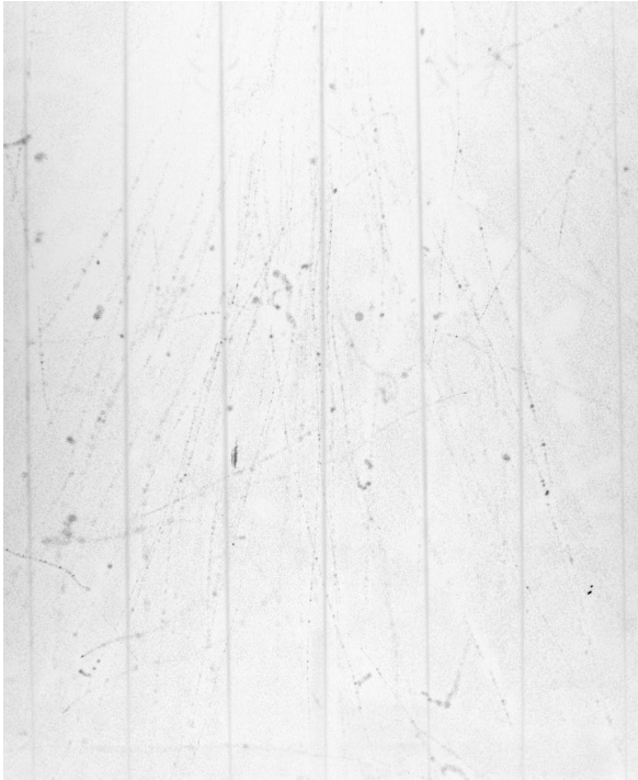
Abb. 4.19: \beta^- -Spuren mit Magnetfeld in die Papierebene. Die Quelle befindet sich oberhalb der Aufnahme, am Ende des ersten Drittels zwischen dem vierten und fünften Heizdraht von links aus gesehen.
