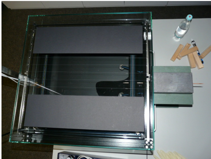
Abb. 4.11: Diese Abbildung zeigt den Versuchsaufbau zum Versuch Winkelverteilung der \delta -Elektronen. Durch den Bleiziegel (mittig rechts im Bild) wurde ein Holzstab in die Nebelkammer eingebracht um die korrekte Ausrichtung des Versuchsaufbaus zu überprüfen.
