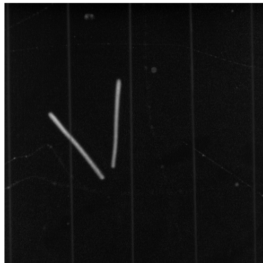
Abb. 4.7: Vollständiger Alpha-Zerfall von Radon bis zu Blei
