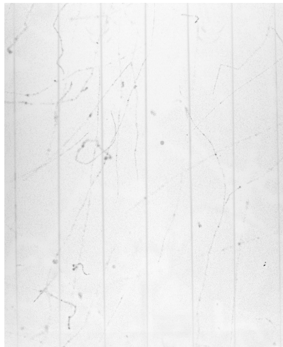
Abb. 4.18: \beta^+ -Spuren mit Magnetfeld aus der Papierebene. Die Quelle befindet sich oberhalb der Aufnahme, am Ende des ersten Drittels zwischen dem vierten und fünften Heizdraht von links aus gesehen.
