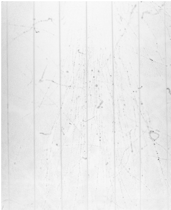
Abb. 4.21: \beta^- -Spuren ohne Magnetfeld. Die Quelle befindet sich oberhalb der Aufnahme, am Ende des ersten Drittels zwischen dem vierten und fünften Heizdraht von links aus gesehen.
