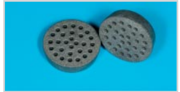
Abbildung 2: Sandgestrahlte Reintitanimplantate mit den Abmessungen 7,35 mal zwei Millimeter mit 28 Bohrkäneln von 600 µm Durchmesser
