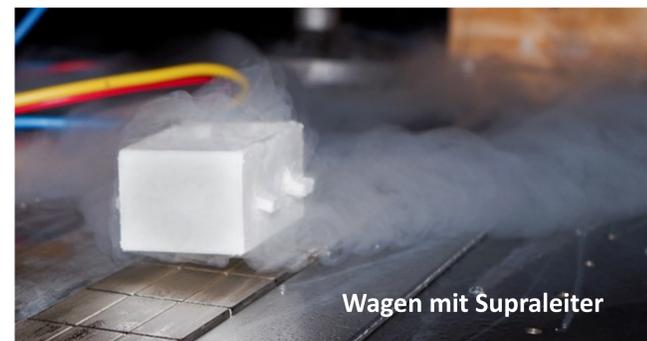
Der Aufbau mit **Supraleitern** ist vergleichbar mit einer Magnetschwebbahn, beruht hier jedoch auf dem Meißner-Ochsenfeld-Effekt. Durch flüssigen Stickstoff ( $-196^\circ\text{C}$ ) schwebt der Supraleiter im Magnetfeld der Schiene.
