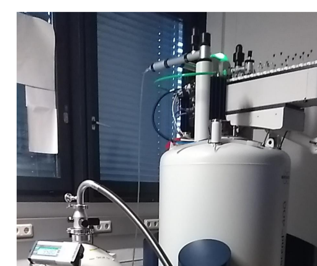
Kernresonanzspektrometer zur Aufnahme von NMR-Spektren
